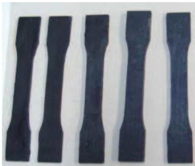
Figura 33- Corpos de prova com Sílica Natural
