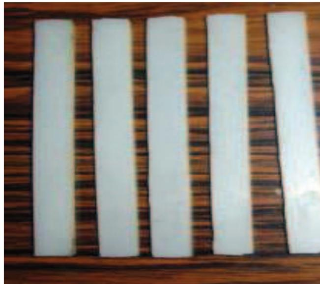
O ensaio de resistência à flexão foi realizado segundo a norma *ASTM D790-07* na máquina de ensaios com capacidade de 20 N, marca EMIC do laboratório do Centro Tecnológico de Polímeros (CETEPO)-SENAI, em São Leopoldo-RS.
